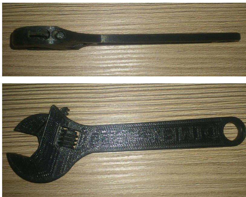
Рис. 4.81. Розвідний ключ виготовлений за допомогою 3-D принтера
