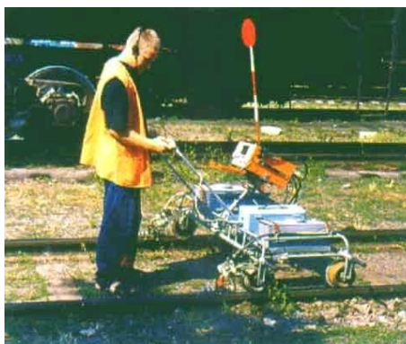
Рис. 3.9 Ультразвуковий контроль рельс на залізниці
